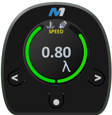
Figura 17: Exemplo de alerta visual de Velocidade na tela de operação.
