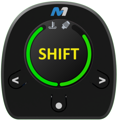
Figura 16: Exemplo de alerta visual do Shift Light na tela de operação.
